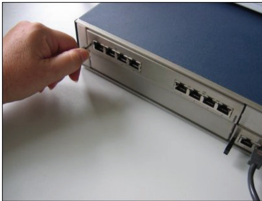
Figure: Boîtier système OpenScape Office MX – Appuyer sur le déverrouillage du module Passerelle
