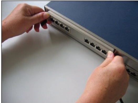
Figure: Boîtier système OpenScape Office MX – Intégration d'un module Passerelle
