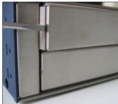
Figure: Boîtier système OpenScape Office MX – Retrait d'un cache d'emplacement
